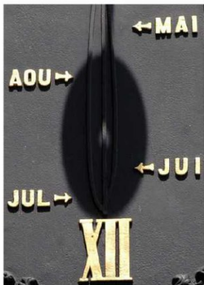
Lorsque la tache blanche passe sur la ligne médiane, la méridienne indique l'heure solaire vraie.
