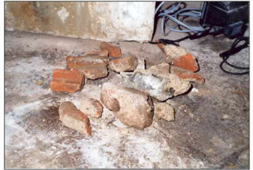
Fragments de tuiles et meule romaine retrouvés dans le béton (chaux) qui a servi de fondation au clocher.
